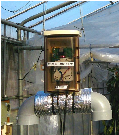
UARDECS で作成した気象観測ノード
