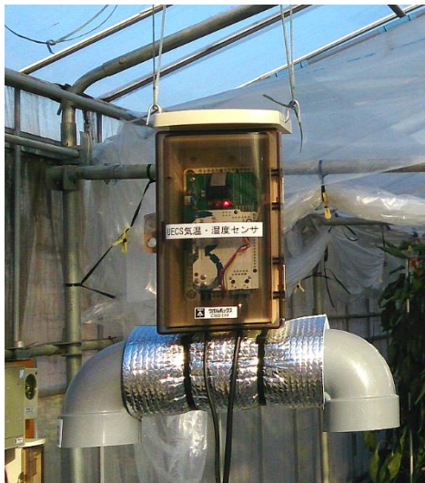
UARDECS で作成した気象観測ノード
